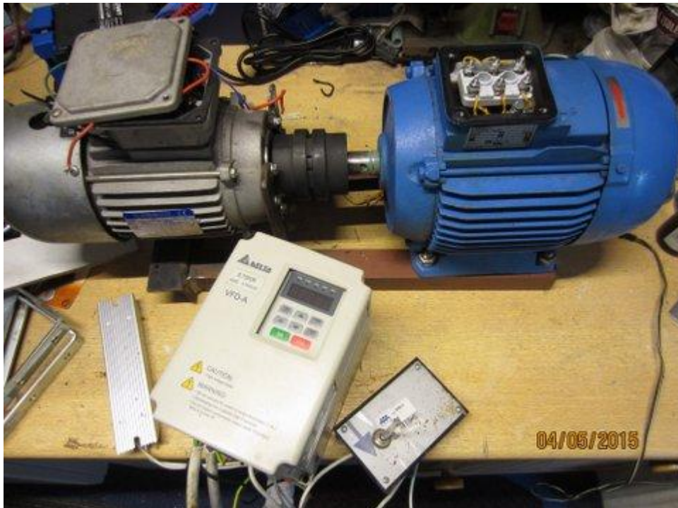
Het witte kastje is de frequentieregelaar met rechts de potmeter
